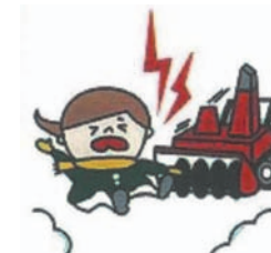
エンジンをかけたまま除雪機に詰まった雪を取り除いていたところ、ロータリー部分に巻き込まれた
