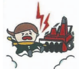
エンジンをかけたまま除雪機に詰まった雪を取り除いていたところ、ロータリ一部分に巻き込まれた
