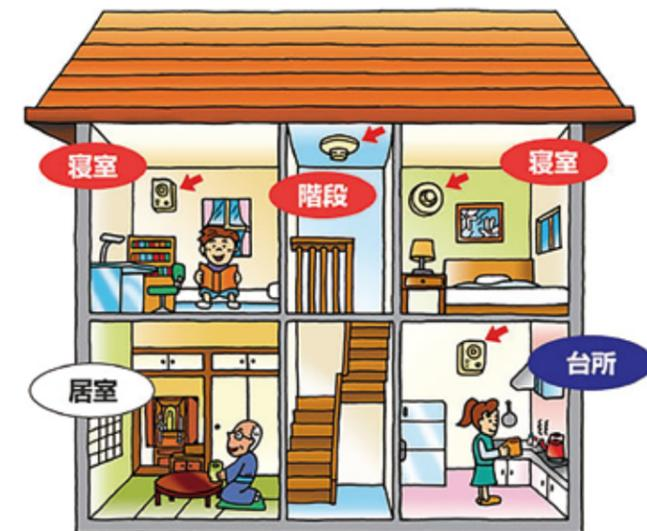
住宅用火災警報器は、住宅火災による死傷者をなくすことを目的として消防法が改正されました。火災発生時において早期の「発見」「覚知」「避難」には大変有効です。しかし、必要な場所に設置されていないと有効に機能しません。また、設置されたあとも「バッテリー切れ」「機器の故障」等もありますので、定期の点検が必要となります。点検は、春と秋の「火災予防運動」を目安に行ってください。
